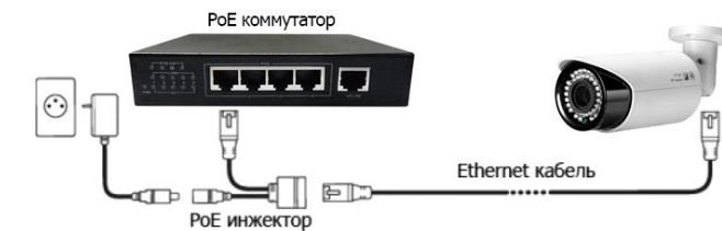
С целью безопасности необходимо обеспечить соответствующее заземление камеры. В случае однофазного заземления системы, импеданс системы должны быть менее 4 О, площадь заземления повода по земле должна быть более 25мм<sup>2</sup>.
