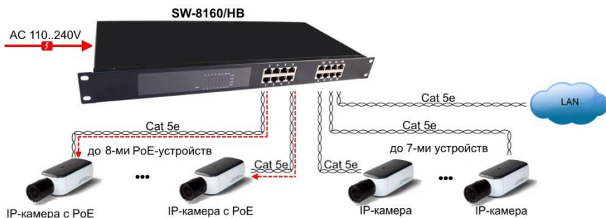
Рис. 3 Схема подключения коммутатора SW-8160/НВ
