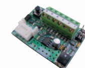
P111408 - SCS WIE Плата для прямого соединения аксессуаров WIEGAND (типа SELETTO, COMPAS SLIM, и т.д.) к модулям управления
