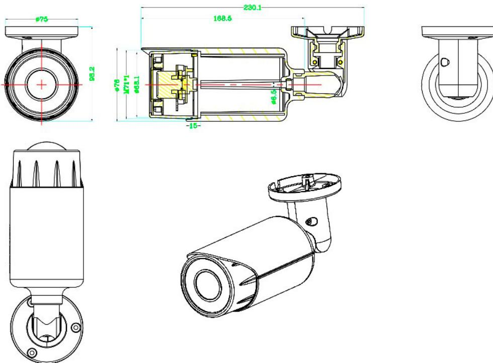
Монтаж видеокамеры необходимо производить на твёрдой устойчивой поверхности. Во избежание попадания влаги на разъёмы видеокамеры, рекомендуем использовать коммутационные коробки, со степенью защиты IP66.
