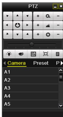
Рис 4.5 Панель инструментов PTZ
