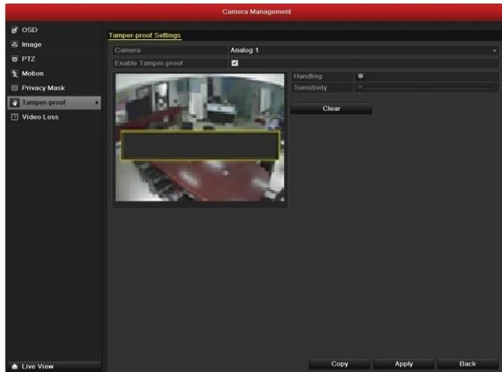
Рисунок 8.16 Установка зоны и чувствительности детекции заслона обзора
