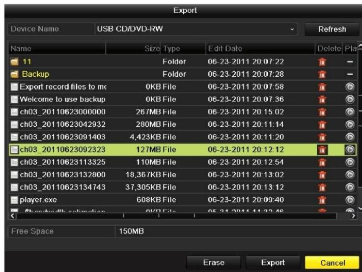
Рисунок 7.14 Проверка результатов экспорта с использованием USB привода
