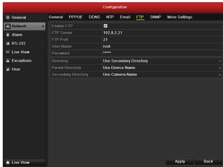
Рисунок 9.11 Конфигурация FTP
