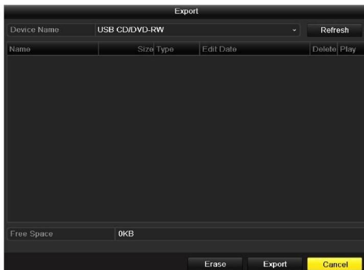
Рисунок 7.12 Экспорт результатов стандартного поиска видео с использованием USB привода
