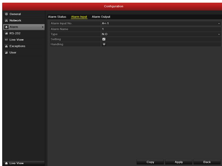
Рис 5.20 Раздел меню Alarm Settings- Alarm Input
