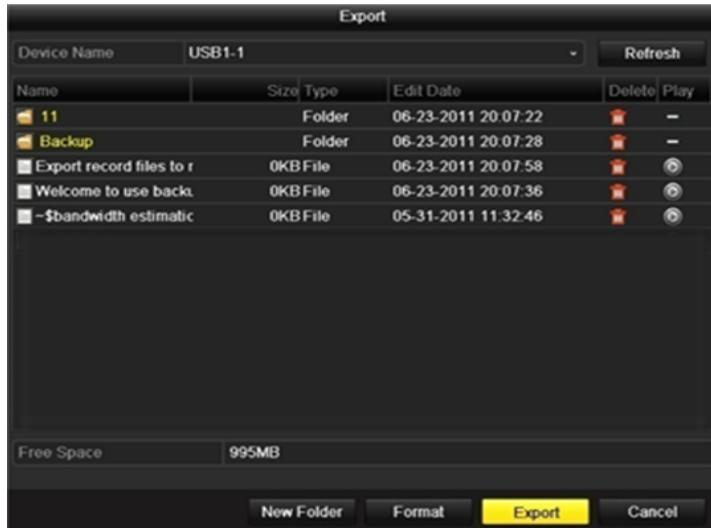
Рисунок 7.23 Экспорт по событию с использованием USB Flash Drive
