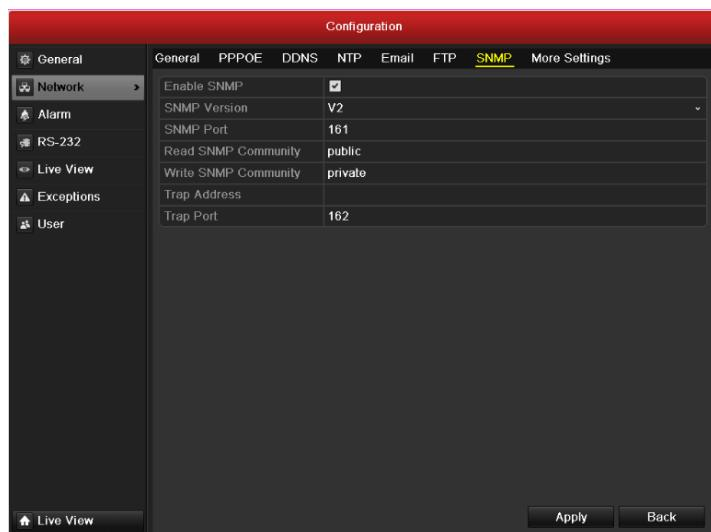
Рисунок 9.13 Конфигурация SNMP
