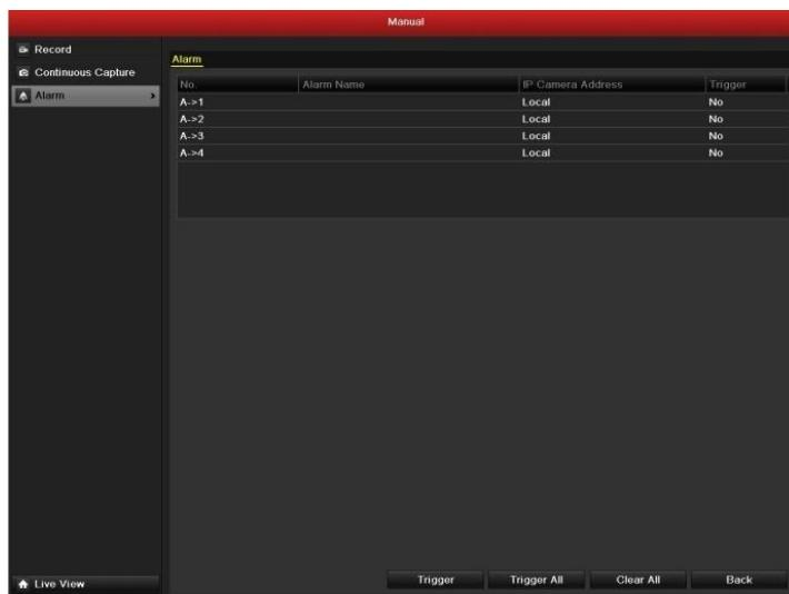
Рисунок 8.23 Активация и деактивация тревожных выходов вручную
