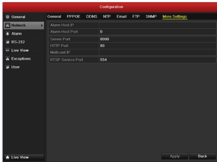
Рисунок 9.17 Интерфейс конфигурации RTSP
