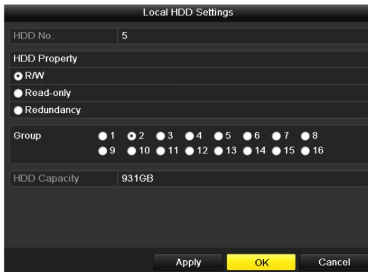
Рисунок 10.14 Интерфейс локальных настроек жесткого диска
