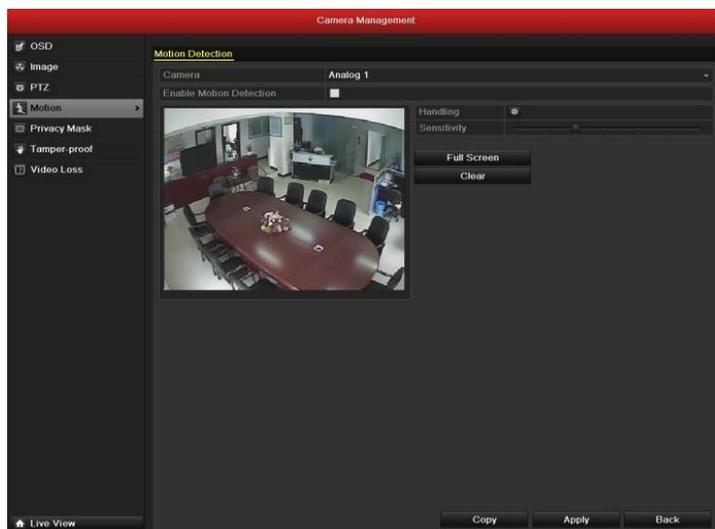
Рисунок 8.1 Интерфейс установки детекции движения
