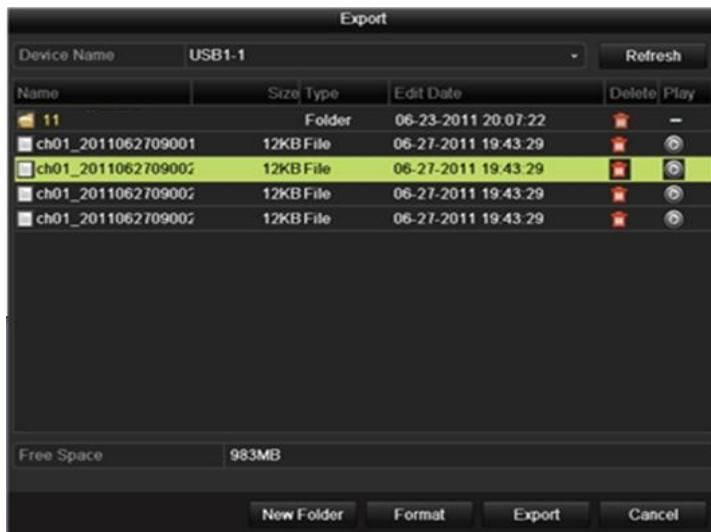
Рисунок 7.35 Проверка экспорта изображений с использованием USB Flash Drive
