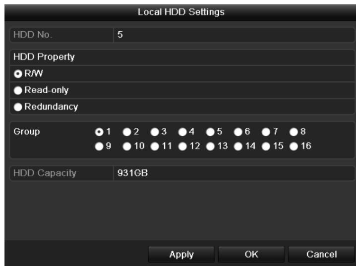
Рисунок 10.16 Установка свойств жесткого диска
