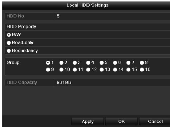
Рисунок 10.16 Установка свойств жесткого диска
