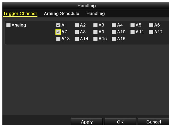
Рис 5.13 Подменю Motion Detection Handling
