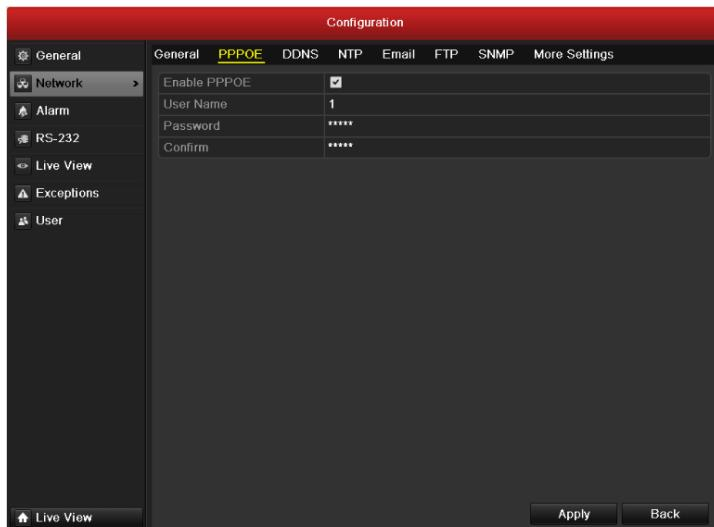
Рисунок 9.3 Интерфейс конфигурации PPPoE
