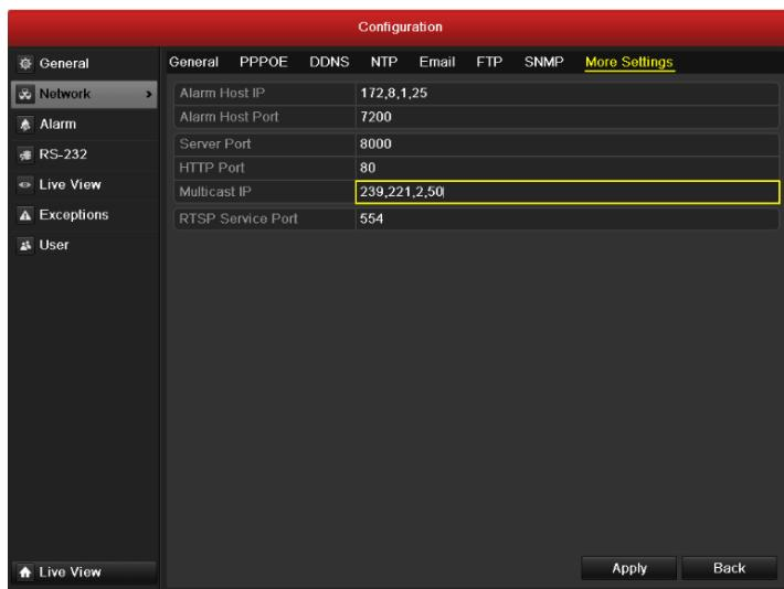
Рисунок 9.16 Конфигурация мультикаста
