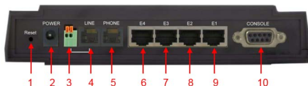
Рис. 4 Элементы задней панели устройств RA-IP4
