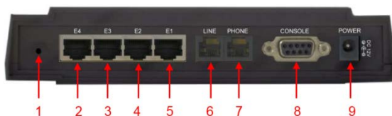
Рис. 3 Элементы задней панели устройств TA-IP4
